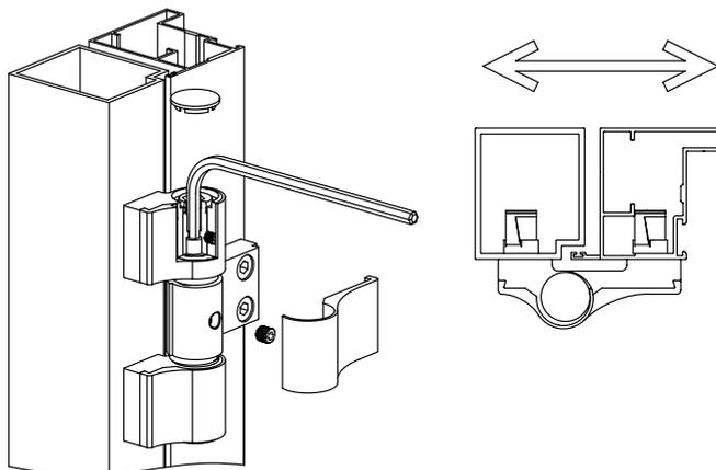
Рис. III. Регулировка петли FLGU.400.1002 в горизонтальном продольном направлении
