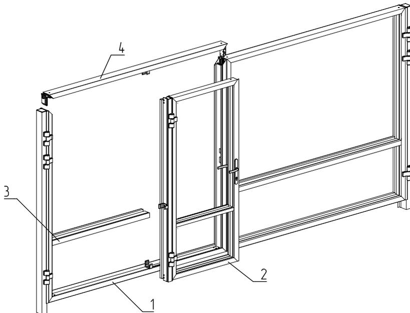
*Рис. 69.* Установка рамы калитки в створку распашных ворот:
