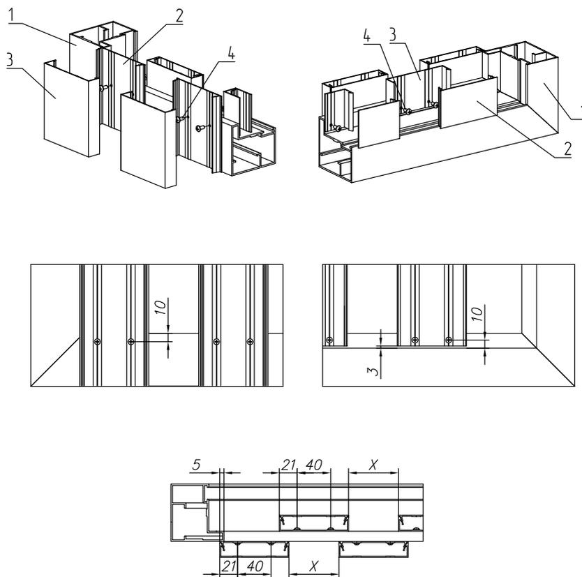
Рис. 29а. Шахматное заполнение профилями шириной 82 мм:
