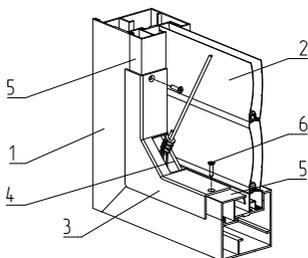
Рис. 20. Установка крышки FLGU.400.0717:
