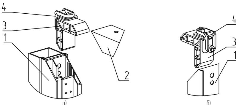
Рис. 7. Установка соединителей:
