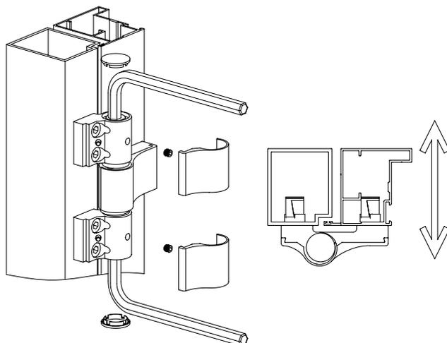
Рис. IV. Регулировка петли FLGU.400.1002 в горизонтальном поперечном направлении
