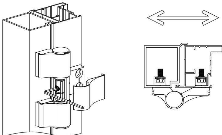
Рис. VIII. Регулировка петли ЗАН67 в горизонтальном продольном направлении
