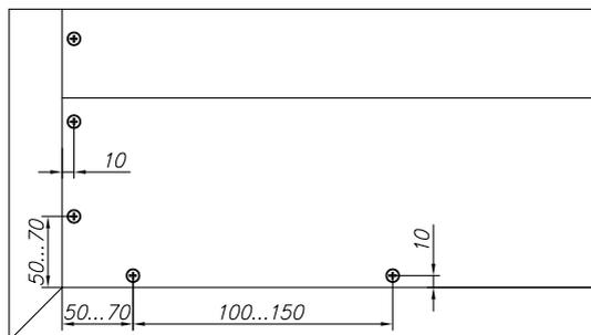
Рис. 15.2. Схема разметки
