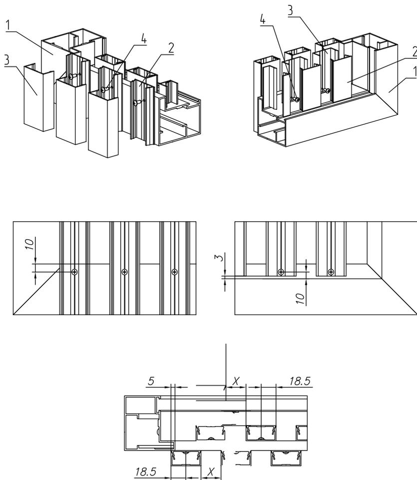
Рис. 296. Шахматное заполнение профилями шириной 37 мм:
