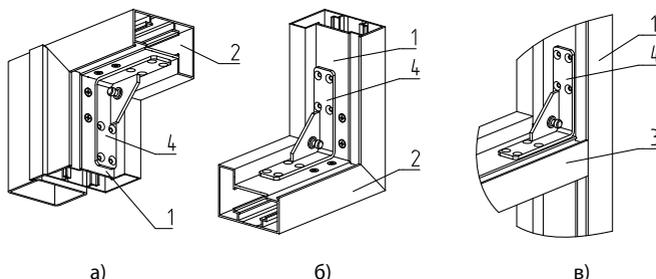
Рис. 13. Разметка отверстий для установки кронштейна FLGU.400.0906:
