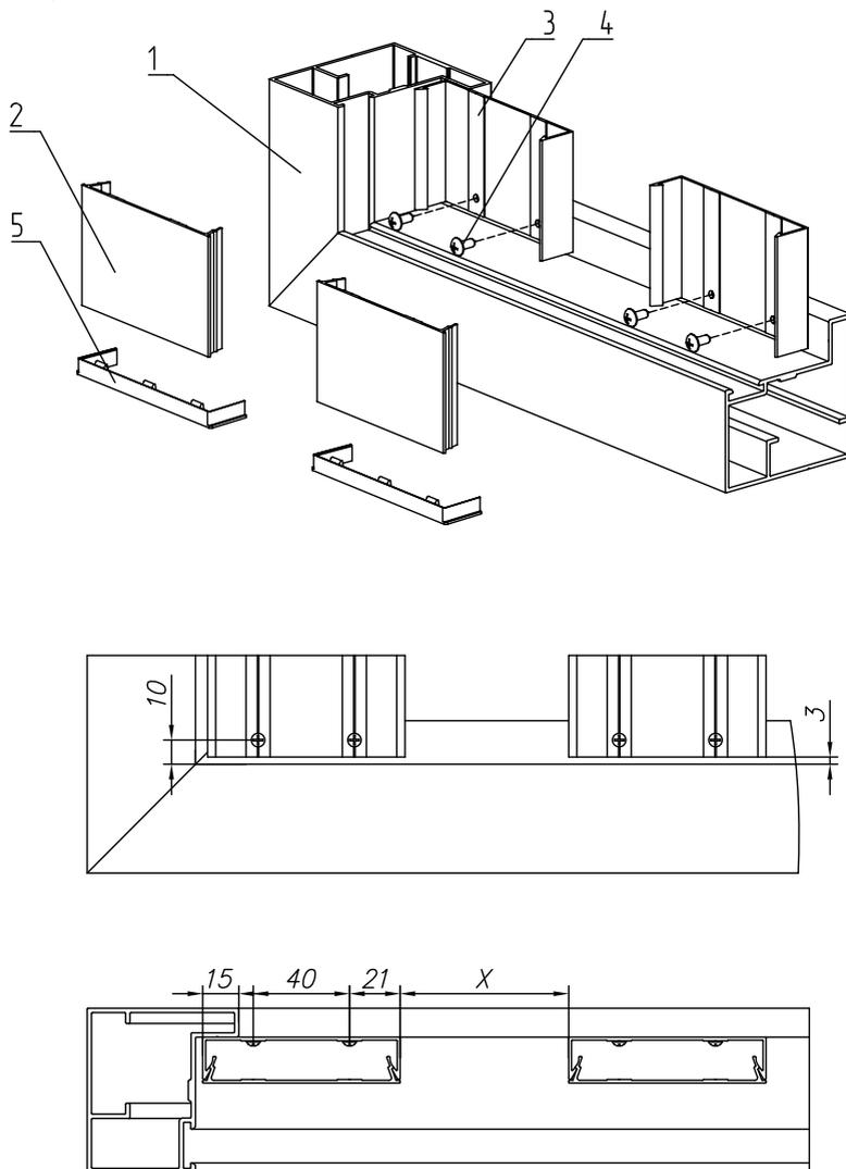
Рис. 24. Встроенный тип монтажа разреженного заполнения профилем 82 мм:
