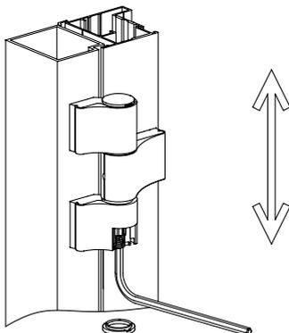
Рис. X. Регулировка петли ЗАН67 в вертикальном направлении
