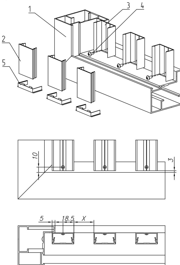
Рис. 25. Встроенный тип монтажа разреженного заполнения профилем 37 мм:
