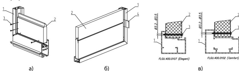
Рис. 16. Установка заполнения из сэндвич-панелей
