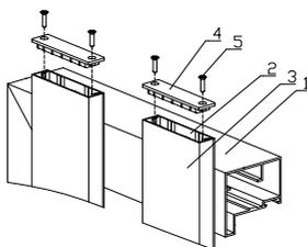
Рис. 34. Установка крышек FLGU.400.0702:
