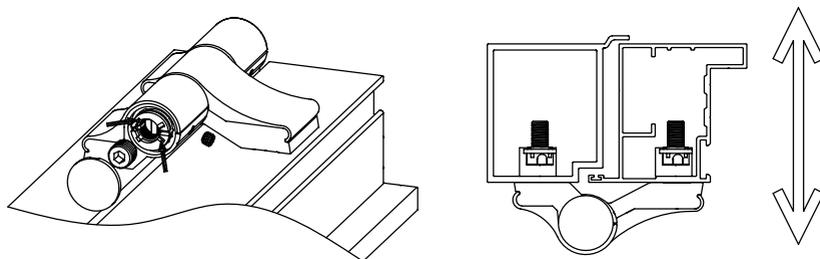
Рис. IX. Регулировка петли ЗАН67 в горизонтальном поперечном направлении
