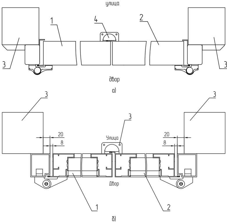
Рис. 51. Распашные ворота (накладной тип монтажа, вид открывания внутрь):
