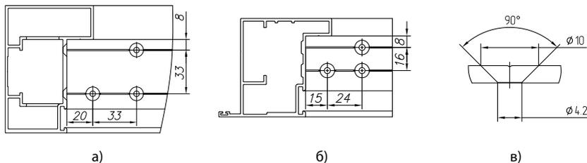
*Рис. 10.* Изготовление отверстий:
