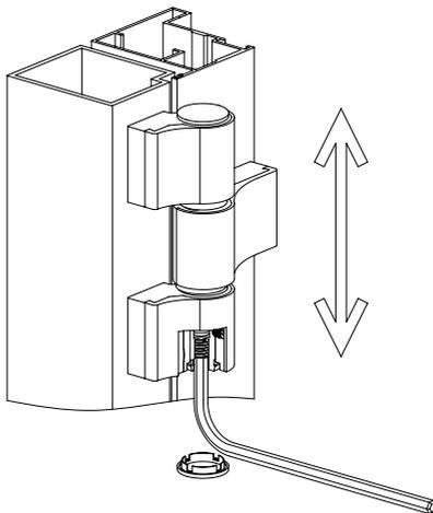
Рис. V. Регулировка петли FLGU.400.1002 в вертикальном направлении
