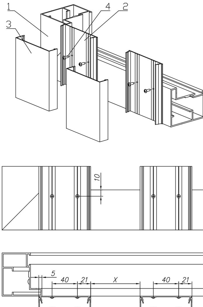
Рис. 27. Накладной тип монтажа разреженного заполнения профилем 82 мм:
